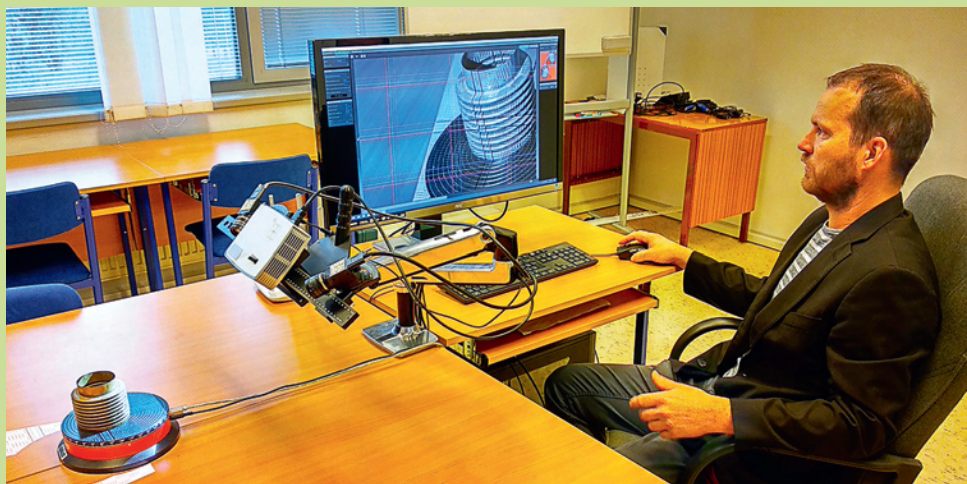
Skenovacie zariadenie za pár sekúnd vytvorí digitálne „mračno bodov“
